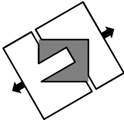
6 Einzige Lösung mit kleinstem Hinterschnitt
