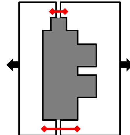
3 Mehrere Lösungen möglich ohne Hinterschneidungen
